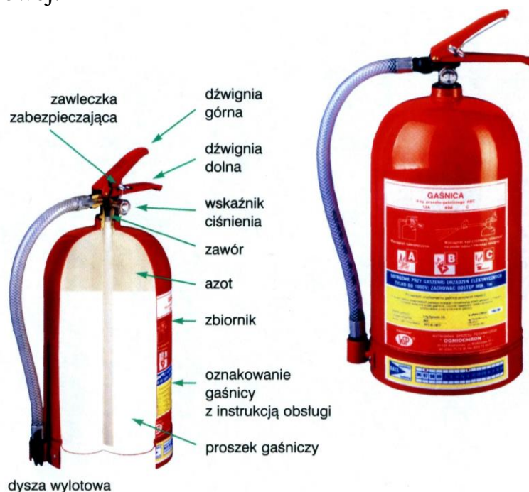
Budowa gaśnicy proszkowej (pod stałym ciśnieniem)
