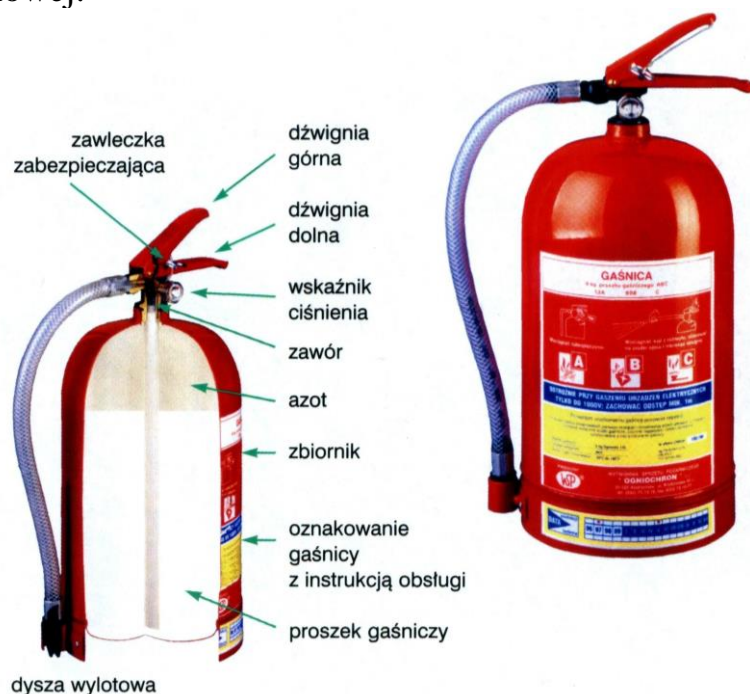
Budowa gaśnicy proszkowej (pod stałym ciśnieniem)
