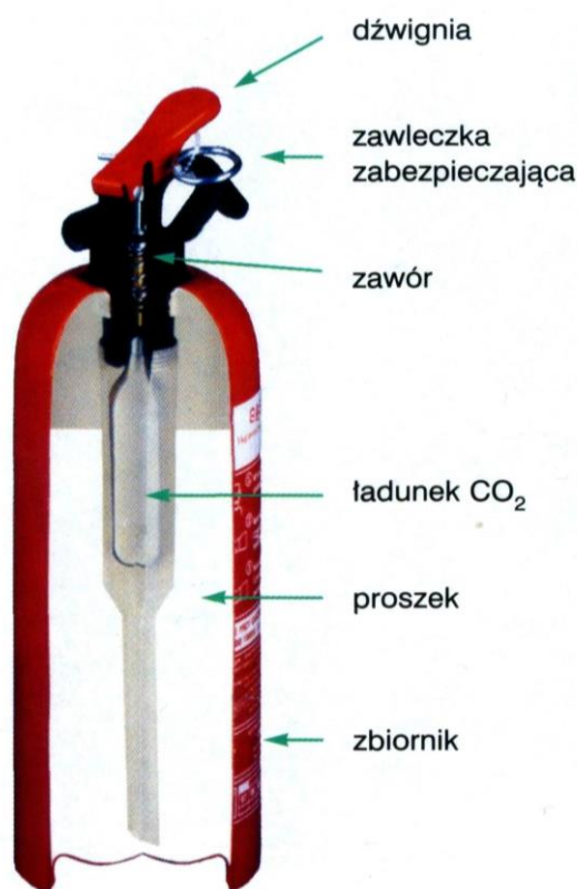
Budowa gaśnicy proszkowej (z ładunkiem - wyrzutnikiem)
